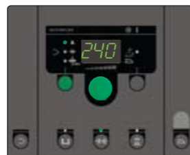
Omega Advanced pozwalającą na uzyskanie spawu przypominającego wynik spawania TIG oraz na lepszą kontrolę jeziorka. Panel Advanced (zaawansowany) zawiera programy do lutowania twardego MIG oraz spawania z użyciem drutów proszkowych lub pełnych w stali miękkiej, aluminium oraz stali nierdzewnej.
