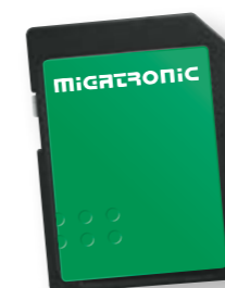
Czytnik programów, łatwo dostępny wewnątrz podajnika drutu, zintegrowany ze spawkami Omega w celu umożliwienia prostego i szybkiego uaktualniania oprogramowania za pomocą karty SD; Spawarki zaprojektowane są tak, aby spełniały nowe wymagania odnośnie do materiałów i gazów osłonowych.
